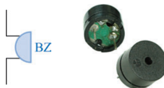
圖 3-45 蜂鳴器的電路符號與外觀
